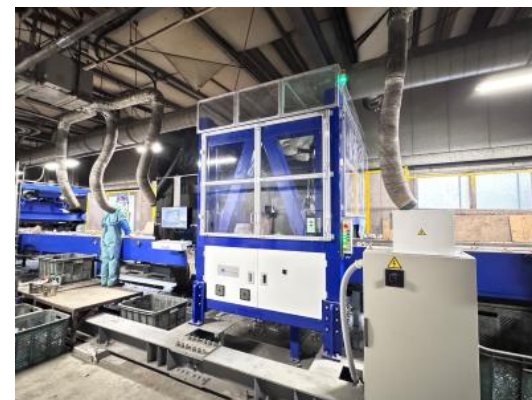
松山容器へ納入した自動選別機 既設コンベアラインに装置を設置し、低コストで導入
