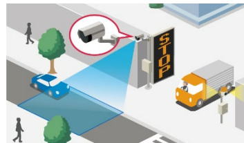
工事車両出入口に接近する一般車両を検知
