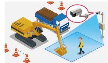
重機の作業半径内への作業員の立入を監視
