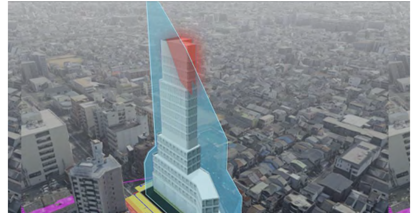
斜線・日影・天空率を3Dで表示し、違反箇所を即時にハイライト
